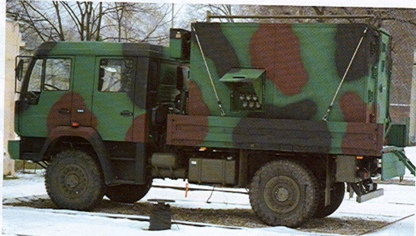
Kontenery z aparaturami komutacyjno-dostępowymi i komutacyjno-bazowymi są przewożone przez terenowe samochody ciężarowe Star 944.
