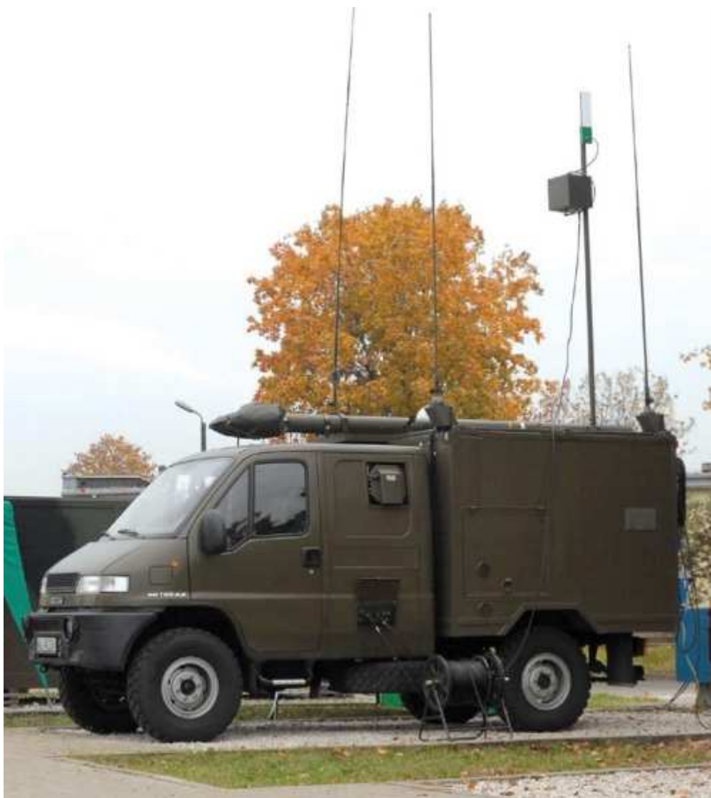
Wóz dostępu radiowego na podwoziu SCAM SMT55 i widok stanowiska zarządzania
