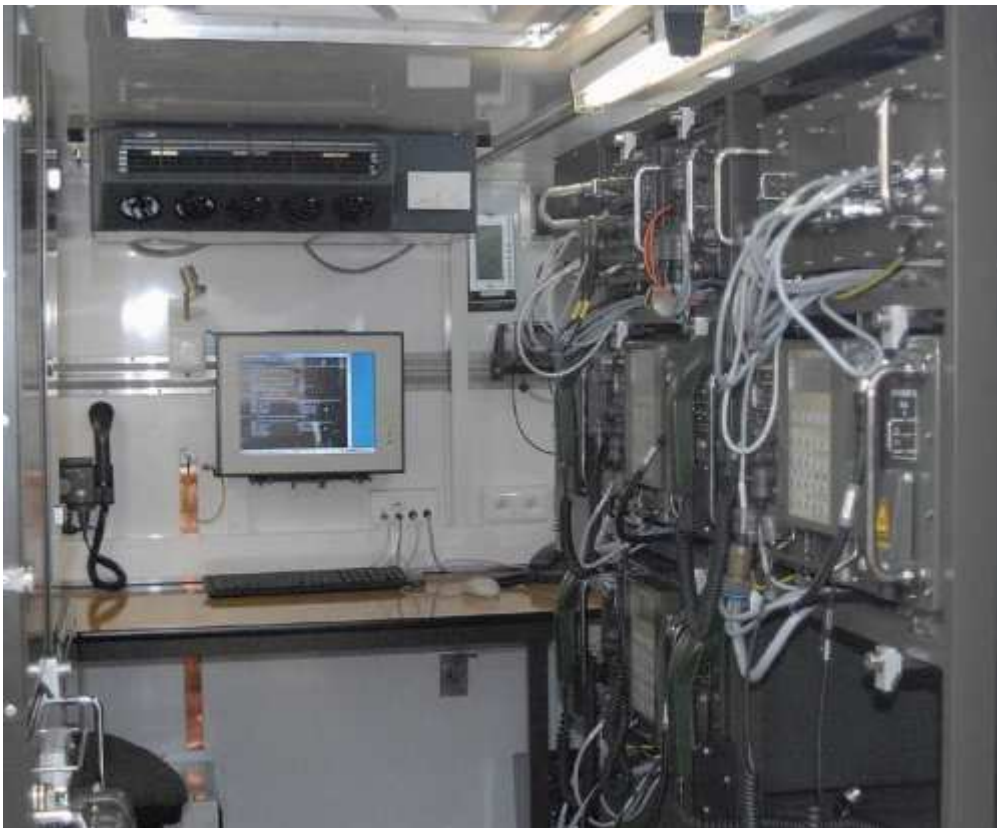
Prototypowe aparatury transmisyjne, komutacyjne i zarządzania systemu Krokus
